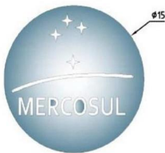
Figura 5 - Marcas d'água de segurança da película retrorrefletiva
