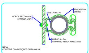
**2 DETALHE FIXAÇÃO DE ELETRODUTO EM METÁLICA**
